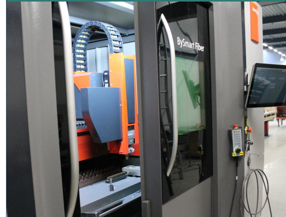
Bystronic Laserschneidanlage mit moderner Glasfasertechnik
